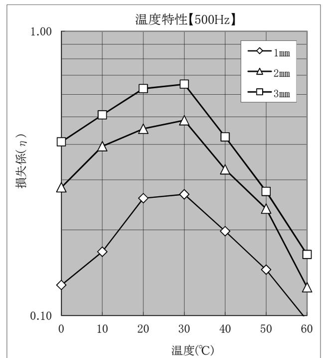
測定方法:JIS K 7391 / 支持法:中央加振法 / 試験片:オバスト梁 / 基材:SPCC-D鋼板0.8mm
